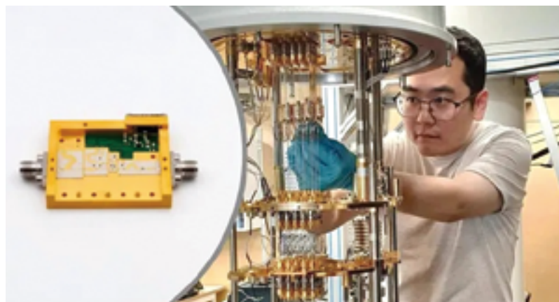
그림 1. 찰머스 공과대학교의 연구자 중 한 명인 인 쟁(Yin Zeng)이 새로 개발된 증폭기를 양자 컴퓨터의 극저온 냉각장치(크라이오스탯)에 장착하고 있다. (출처: Chalmers University of Technology, Yin Zeng/Maurizio Toselli)
